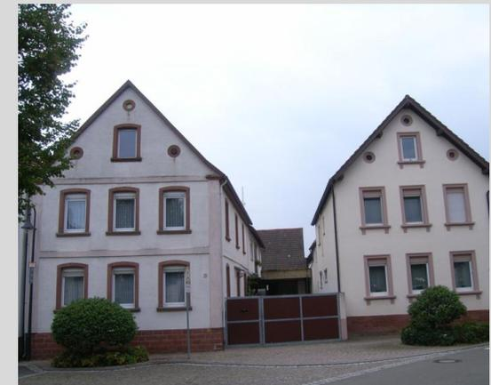
**Waagrechte Fassadengliederung** durch Fenster, Stockwerkgesimse, Dachtraufen, Sockelzonen
